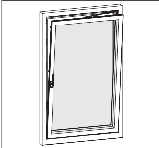
1 Die Entlüftung geschieht in der Kippstellung.
